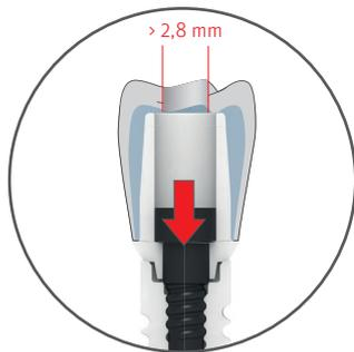
Der Durchmesser des Schraubenkanals für die Vicarbo Schraube muss bei der **SB/RB/WB-Plattform > 2,8 mm** betragen.
