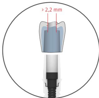
Der Durchmesser des Schraubenkanals für die durchmesserreduzierte Variante muss **> 2,2 mm** betragen.
